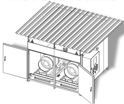
Etuve électrique pour 2 fûts en position horizontale, selon ATEX, avec dispositif de pesage et détection de gaz.
