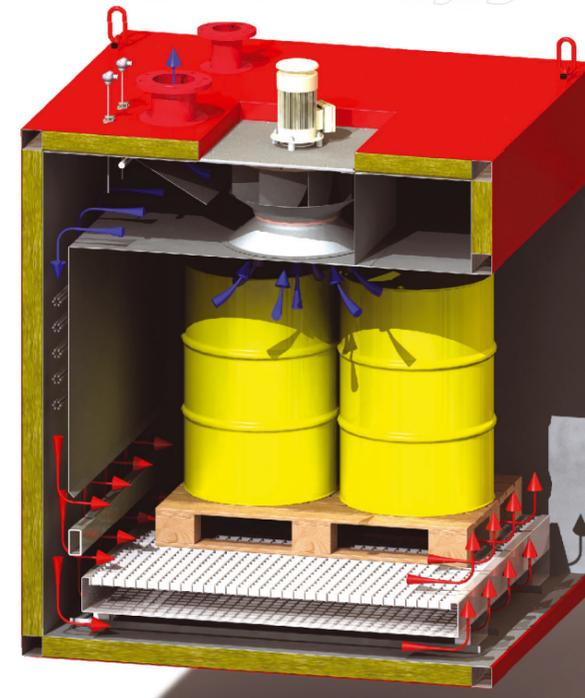
Cependant, en plus d'une capacité optimale, il est absolument nécessaire de pourvoir un guidage d'air effectif. Afin de profiter de manière optimale du courant d'air, le guidage doit être direct. C'est à dire qu'un échauffement homogène n'est obtenu que si l'air entre dans l'étuve couvrant un maximum de l'espace intérieur.
