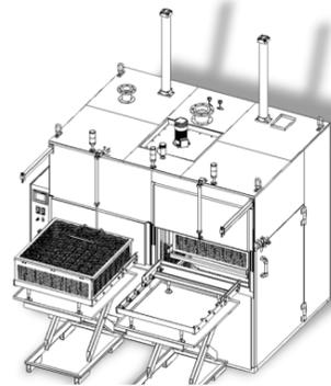
Etuve électrique pour la fabrication de condensateurs, avec transporteur à bande par chaînes, commandé par SPS, en deux zones de chauffage.
