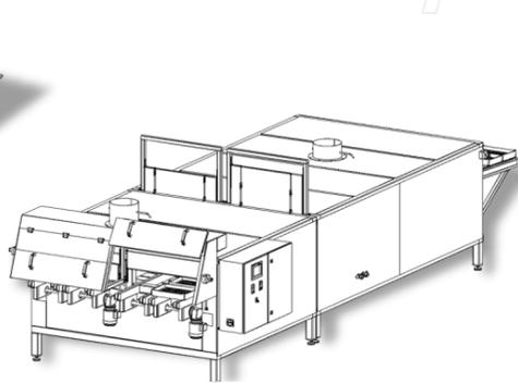
Etuve électrique pour chauffer des bobines de câble dans un bain de graisse, avec automatisme de remplissage par commande SPS.
